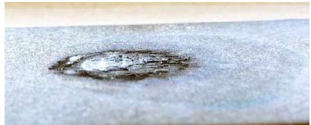
Soldadura por puntos eliminada
