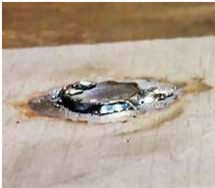
Soldadura por puntos en la placa inferior
